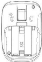
5. Deslice la cubierta del compartimento de las pilas AAA para volver a colocarla en su sitio, de forma que quede alineada con las ranuras abiertas, y ciérrela con firmeza.
