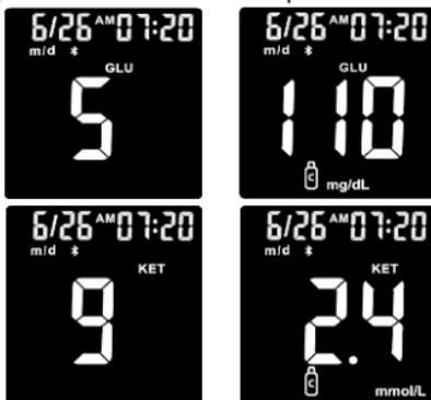
**Nota:** El medidor reconocerá y marcará automáticamente el resultado de control para usted. Los resultados de control no están incluidos en el cálculo medio a 7, 14 y 30 días.
