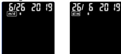
El mes ahora parpadea, presione el botón lateral para ajustar el mes. Presione el botón de encendido hasta que el medidor emita un pitido para configurar.
