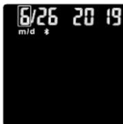
La fecha ahora parpadeará. Presione el botón lateral para ajustar la fecha hasta que se complete la configuración de la fecha, luego presione el botón de encendido hasta que el medidor emita un pitido para configurar.
