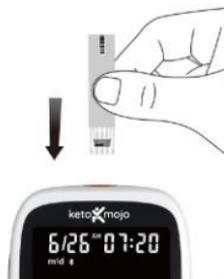
3. El medidor se enciende tras emitir un pitido. Aparecerá la imagen de una tira reactiva y una gota de sangre parpadeando, lo que le indica que el medidor está listo para realizar la prueba.
